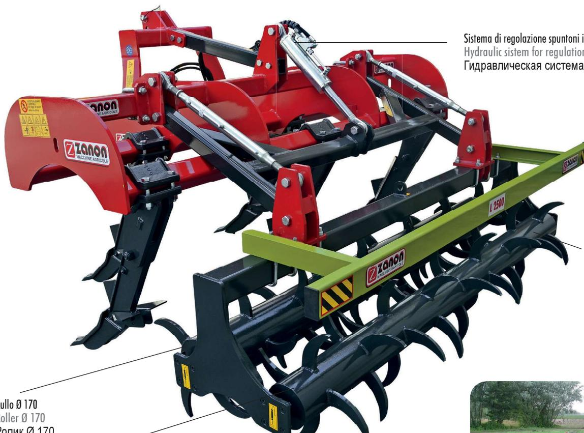
Sistema di regolazione spuntoni idraulico.
